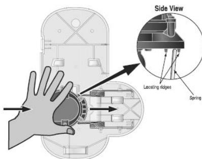
3. Enfoncez le largueur hydrostatique dans la position indiquée. Réinsérez l'axe de maintien avec le détrompeur vers l'arrière.
